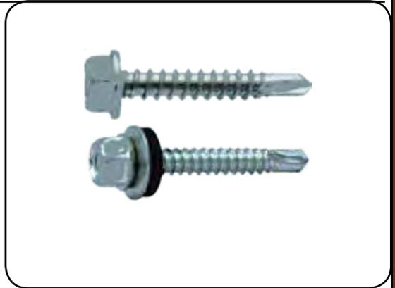
**Aplicaciones:** Fijación de remates de chapa, omega, chapa perfilada, y accesorios a estructura metálica con espesor menor de 6 mm.
